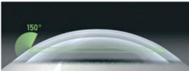
Abb. 4: Die Schnittkonfiguration für einen 150-Grad-Randschnitt.
